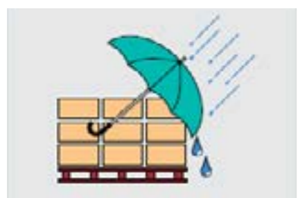
Protéger des salissures et de la pluie les blocs clivés stockés sur chantier.
