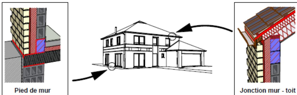
Le tableau ci-dessous compare la valeur  $\Psi$  des nœuds constructifs (selon les schémas ci-dessus) entre un bloc ISO-Line et un bloc de béton cellulaire.
